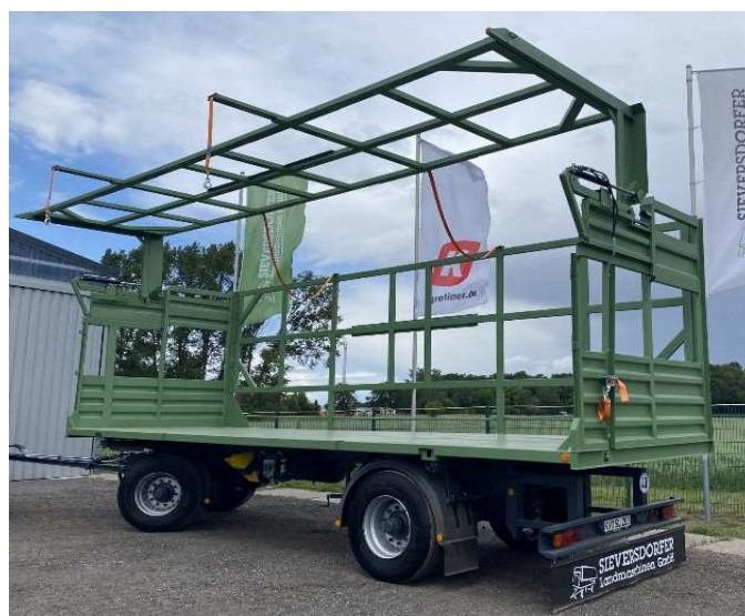
BTA 8200 in RAL 6011 auf einem aufbereiteten Wechselbrückenfahrgestell
